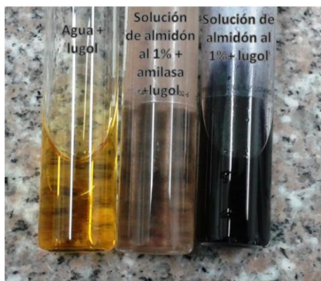
Figura 1.6 Determinación cualitativa de la degradación de almidón
