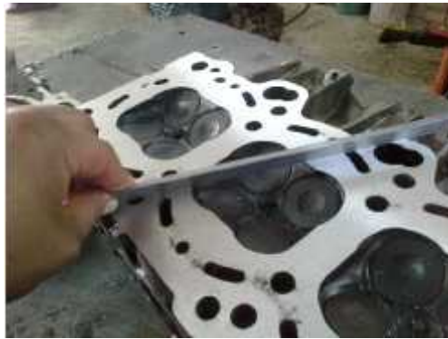
Figura 12. Verificación de la planitud de un cabezote
