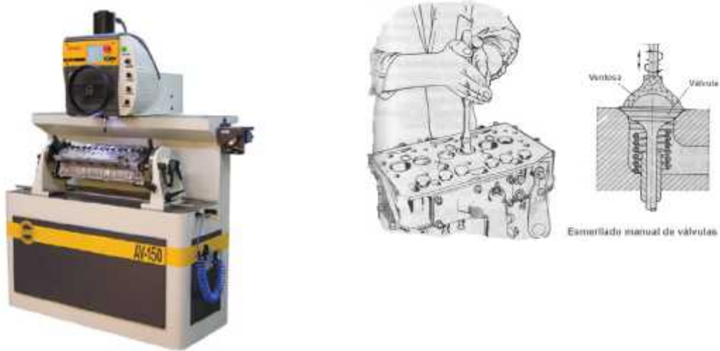
Figura 15. Rectificadora de asientos de válvulas y procedimiento manual
