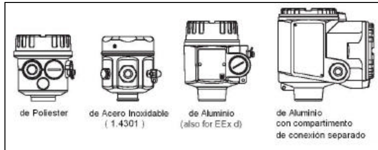
FIGURA 3.11 Tipos de carcasas: Poliéster, Acero inoxidable y aluminio
