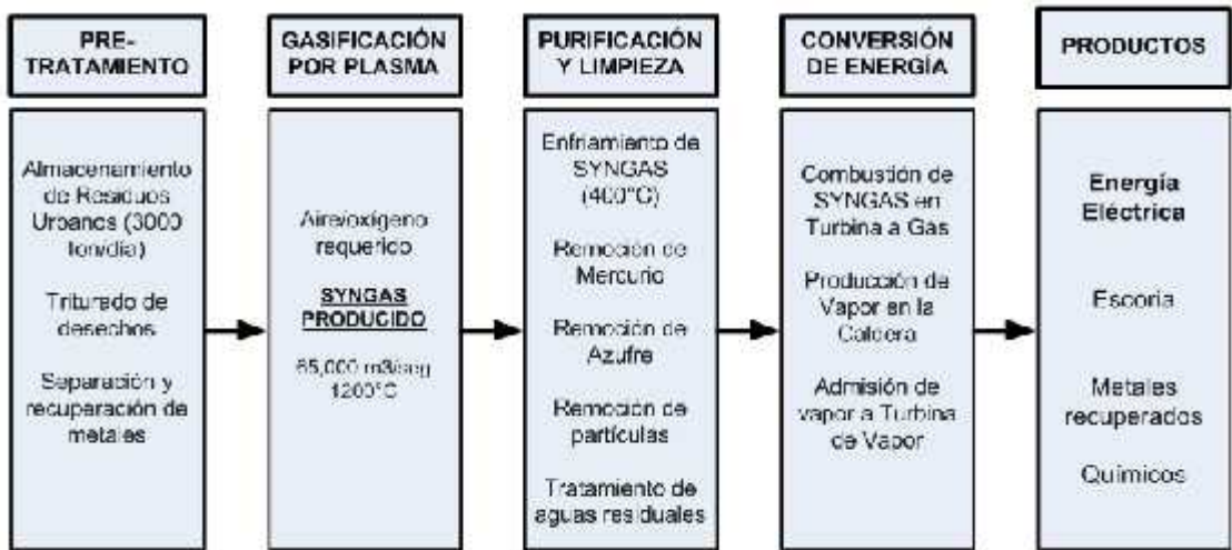
Gráfico13. Diagrama de procesos de operación de la planta de Gasificación. Fuente:Biomax S.A.
