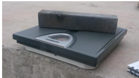
Fotografía 3.13: Pesaje de la muestra del material Perfil Metálico
