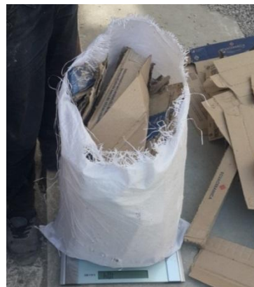
Fotografía 3.6: Obtención del peso de cartón desechado en obra.
