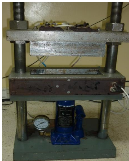
FIGURA 2.21. EQUIPO PARA PENSADO EN CALIENTE
