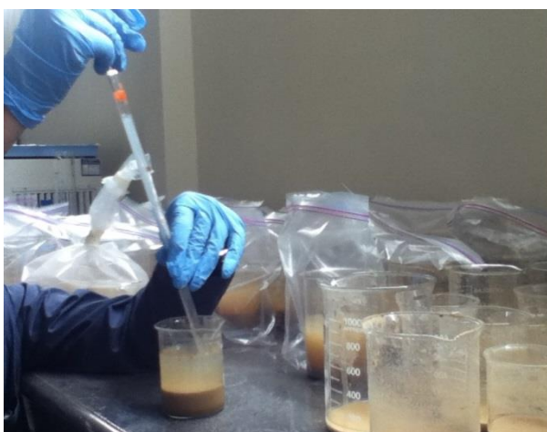
FIGURA 2.35. ELIMINACIÓN DE LÍQUIDO SOBRENADANTE
