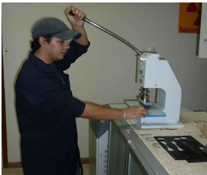
FIGURA 2.49. CORTE DE PLACAS EN EL TROQUEL
