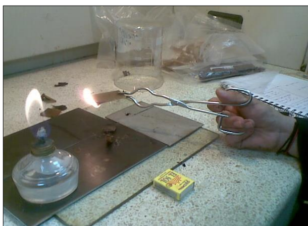
FIGURA 2.53. ENSAYO DE FLAMABILIDAD
