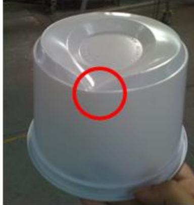
**FIGURA 4.1 ERROR EN EL TERMOFORMADO DE TARRINAS.**
