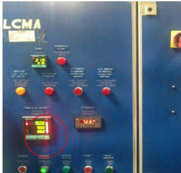
**FIGURA 4.30 TABLERO DE PRESIONES DE LA EXTRUSORA.**
