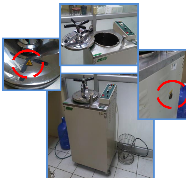
Figura 3.24: Tamaño de señalética inadecuado, válvula de drenaje mal ubicada.
