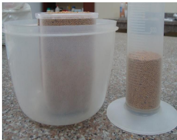
Figura 3.1: Método de desplazamiento para análisis del volumen del pan
