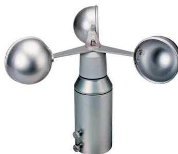
Figura 2.2. Anemómetro de 3 cazoletas
