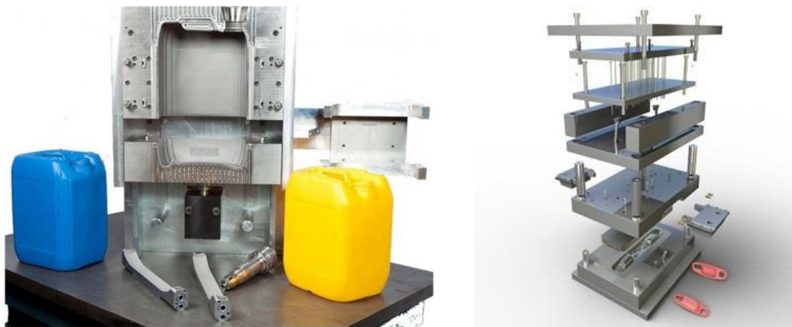
Imagen 7.2 Molde de extrusión o de inyección
