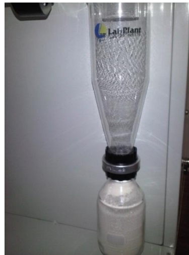
FIGURA 2. 7 Proceso de secado del látex
