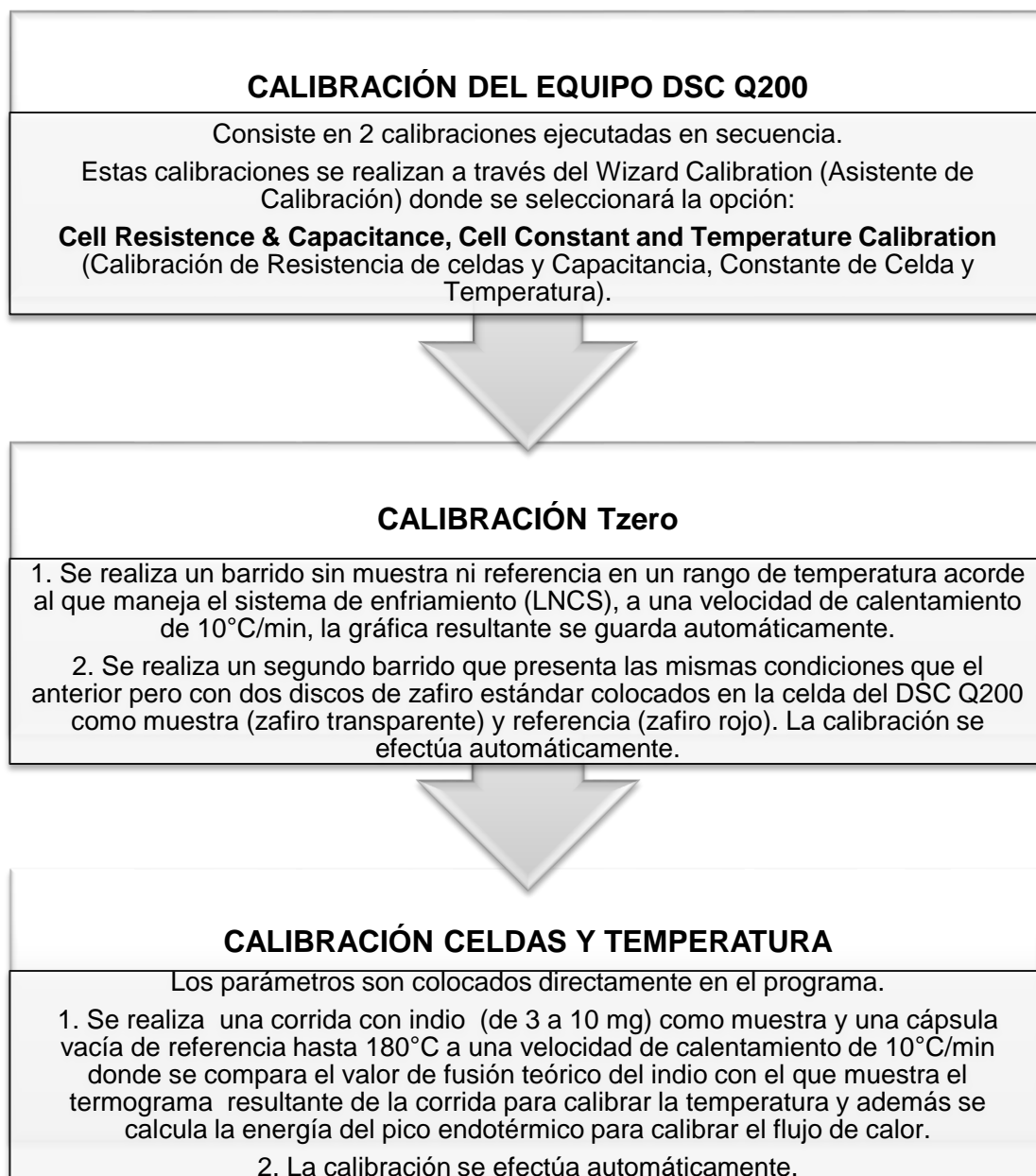
FIGURA 3.6 CALIBRACIÓN DEL EQUIPO DSC Q200
