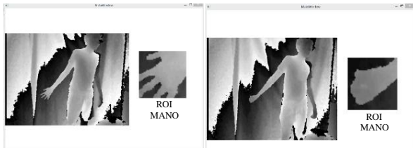
Figura 9. A la derecha de cada imagen de profundidad se muestra el área de píxeles que cubre el ROI seleccionado para seguir el movimiento de la mano.
