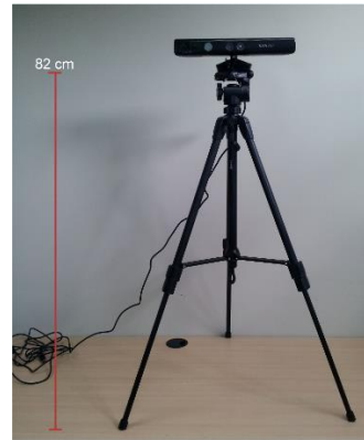
Figura 3. Altura del sensor Kinect usando un trípode de soporte.
