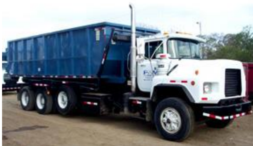
Fig. 1.10. ROLL- ON CON CONTENEDOR DE 25m 3 .
