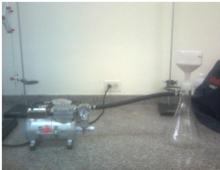
FIGURA 4.2. EQUIPOS DE FILTRADO
