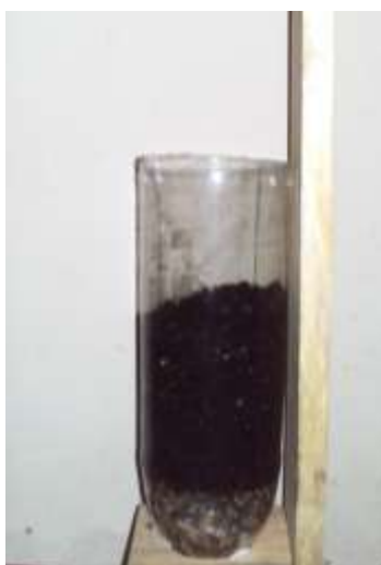
Figura 3.6 Filtro de Carbón Activado.
