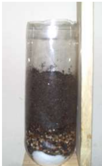
Figura 3.5 Filtro de Arena.
