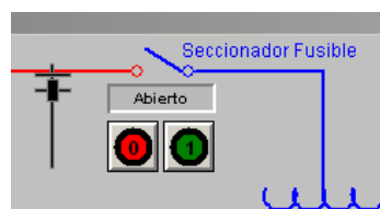
FIGURA 5.4. BOTONERA DE FUSIBLE A.T. DEHABILITADA
