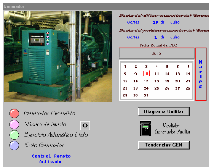
FIGURA 5.20. PANTALLA DE CONTROL DEL GENERADOR
