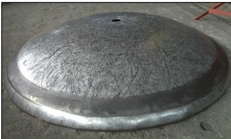
FIGURA 3.12: TAPA BOMBEADA Y REBORDEADA.
