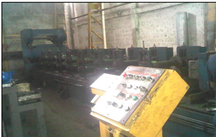
FIGURA 3.7 PERFILADO DE CORREAS
