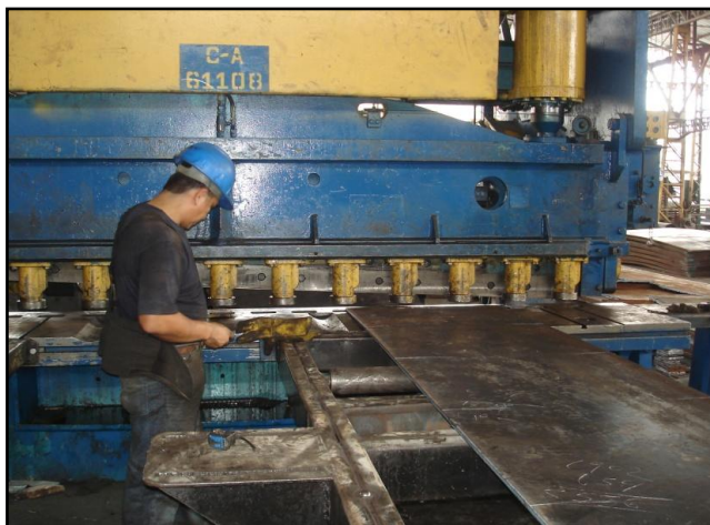
FIGURA 3.2: GUILLOTINA PESADA, CALIBRACIÓN PARA CORTE 10MM.
