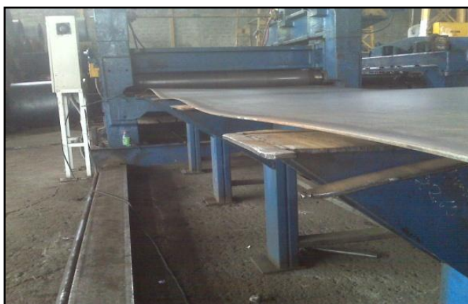
FIGURA 3.8 OBTENCIÓN DE PLANCHAS ALISADAS.
