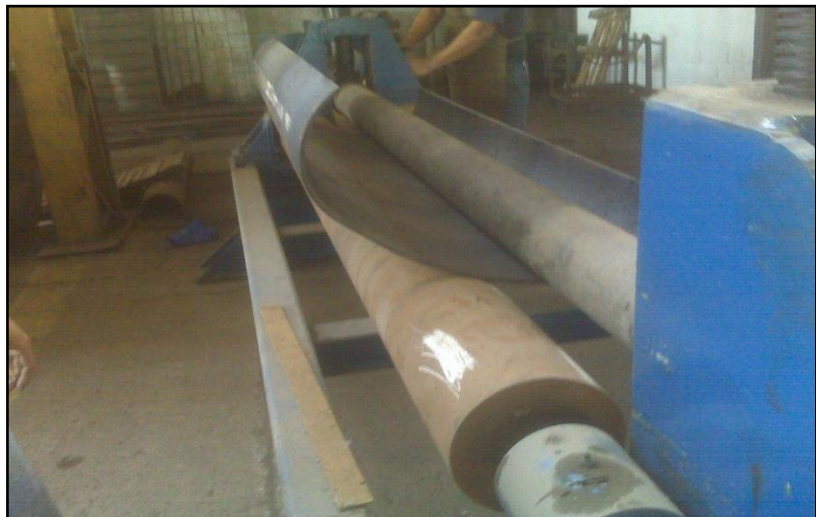
FIGURA 3.4: MÁQUINA ROLADORA DE PLANCHAS LIVIANA.
