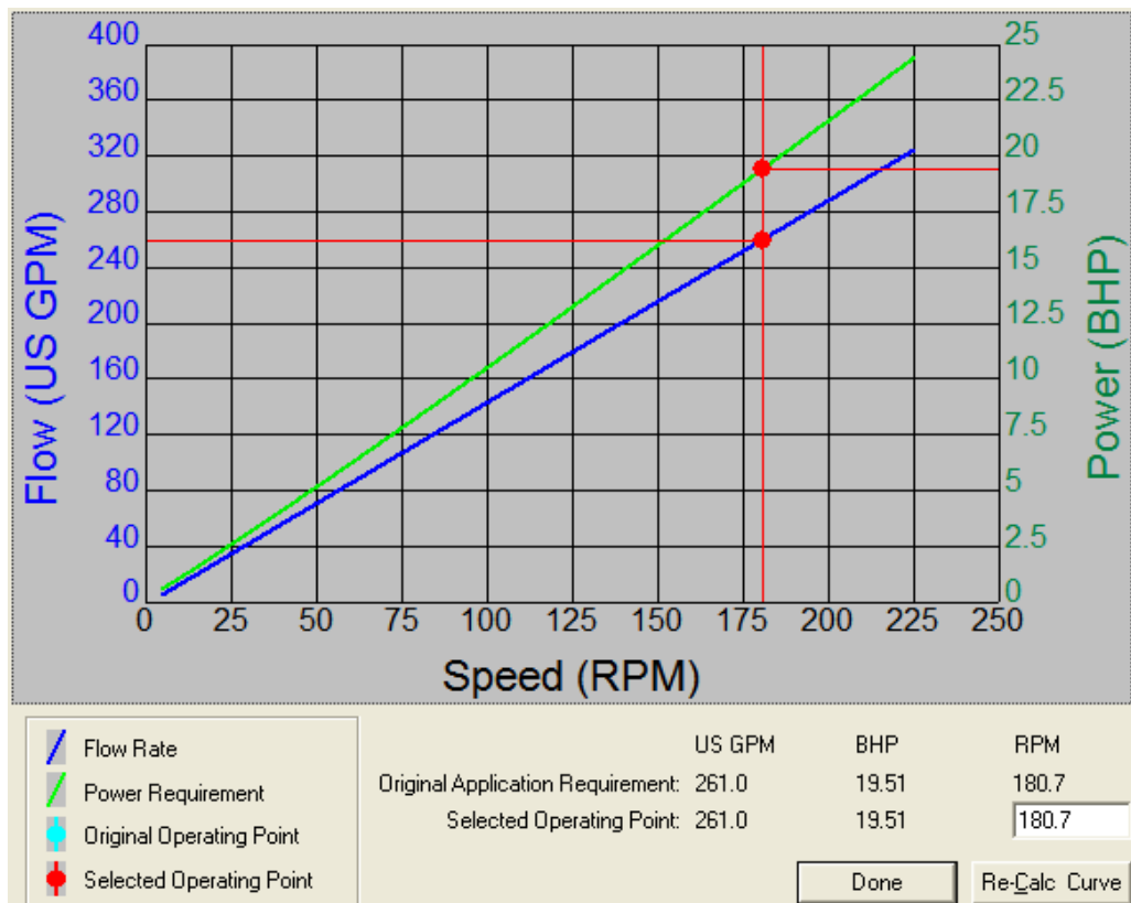
FIGURA 4.10. CURVA DE RENDIMIENTO DE BOMBA DEL SISTEMA DE TRASVASE
