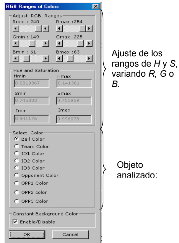
Figura 4-3. Modificación de los rangos [H^1_{min}, H^1_{max}] y [S^1_{min}, S^1_{max}] manipulando R , G o B del objeto.
