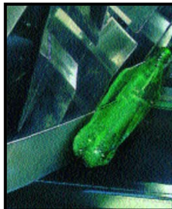
FIGURA 3.13 DESPLAZAMIENTO DE BOTELLA POR FUERZA CENTRIFUGA
