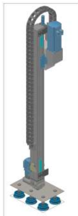
FIGURA 3.49. ENSAMBLE SISTEMA VENTOSAS- ACTUADOR GIRATORIO-ACCIONAMIENTO EJE Z
