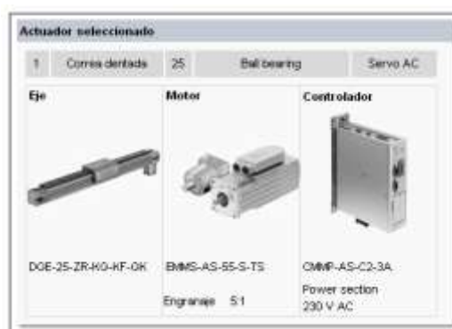
FIGURA 3.57. ACTUADOR SELECCIONADO EJE Y
