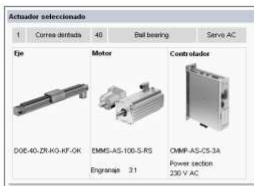
FIGURA 3.67. ACTUADOR SELECCIONADO EJE X
