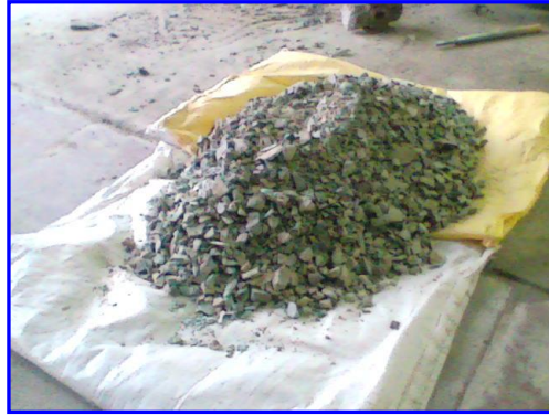
FIGURA 3.8. ZEOLITA AL SALIR DE MOLINO DE MANDÍBULAS.
