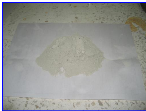
FIGURA 3.16. ZEOLITA CON GRANULOMETRÍA FINAL 45 \mu m
