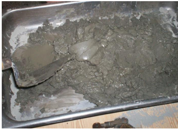
FIGURA 3.19. OBTENCIÓN DE LA PASTA DE CEMENTO COMPUESTO.
