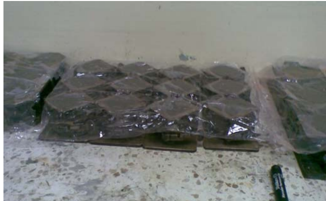
FIGURA3.12 PROBETAS CUBIERTAS DE PLÁSTICOS
