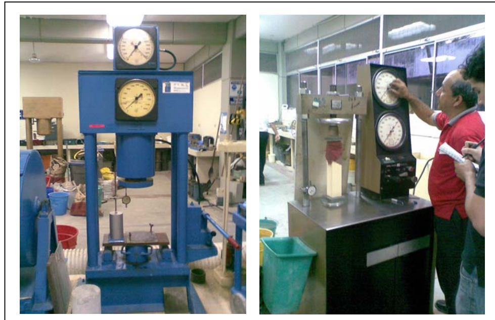
FIGURA 3.14 MAQUINAS PARA ENSAYOS DE COMPRESIÓN
