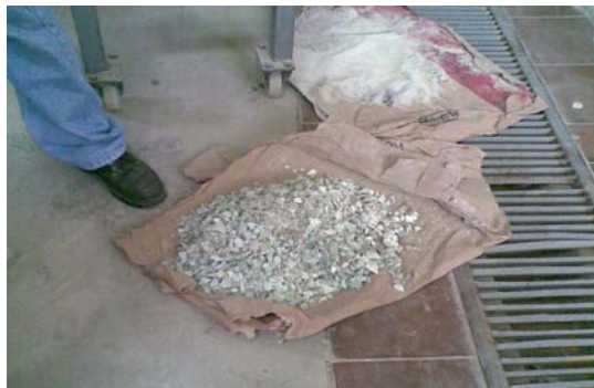
FIGURA 3.6 TAMAÑO DE LA ZEOLITA DESPUÉS DE LA TRITURADORA DE RODILLOS
