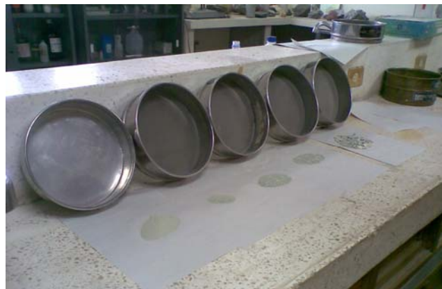
FIGURA 3.7 RESULTADO DEL PRIMER TAMIZADO
