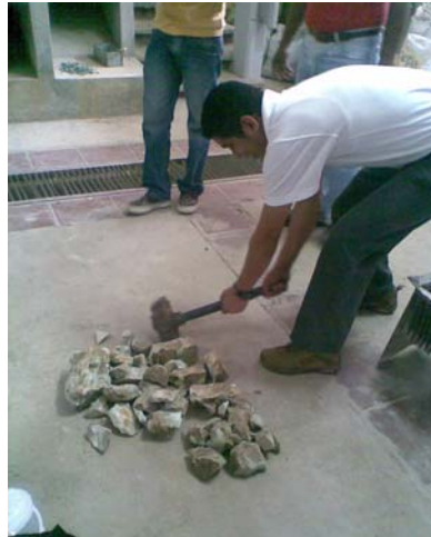
FIGURA 3.3 REDUCCIÓN MANUAL DEL TAMAÑO DE LA ZEOLITA 2
