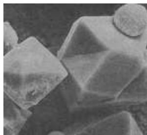
FIGURA 2,3 ZEOLITA FAUJASITA. Observada en el microscopio electrónico de barrido. Los cristales son de 50 \text{ \AA} aproximadamente.
