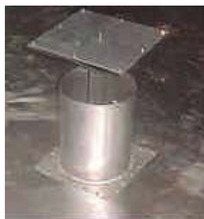
FIGURA 3.14 VALVULAS ROMPE VACIO
