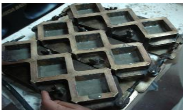
FIGURA 3.9. LLENADO DE PRIMERA CAPA DE MEZCLA
