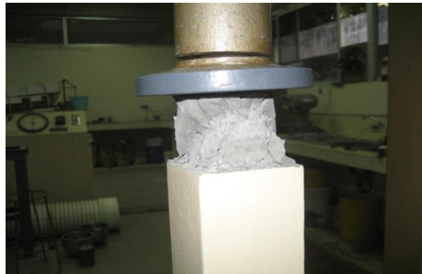
FIGURA 3.11. PROBETA DEFORMADA EN ENSAYO DE RUPTURA
