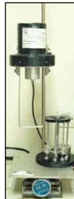
FIGURA 2.5. VISCOSÍMETRO ROTACIONAL, MARCA BROOKFIELD MODELO RVT
