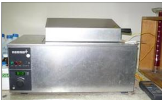
FIGURA 2.4. EQUIPO DE BAÑO MARÍA Y TERMÓMETRO DIGITAL UTILIZADOS PARA REALIZAR LAS PRUEBAS EXPERIMENTALES DE TRATAMIENTO TÉRMICO
