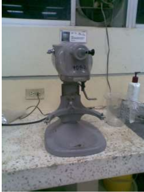
Dispositivo para realizar la mezcla de los agregados en seco y con agua
