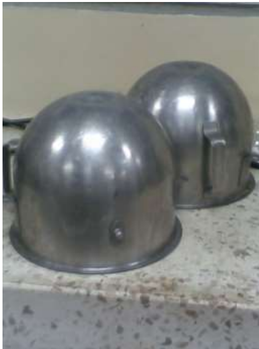
Recipientes de almacenamiento de agregados
