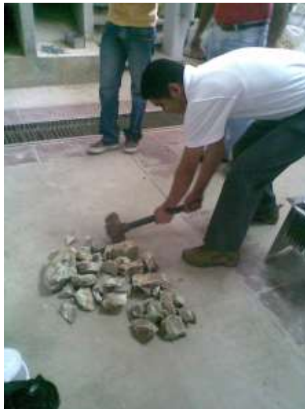
Ruptura de rocas de mineral con martillos grande para reducir tamaño de piedras
