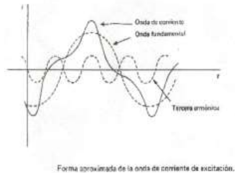
FIGURA 2.16 COMPONENTES DE LA CORRIENTE DE EXCITACIÓN
