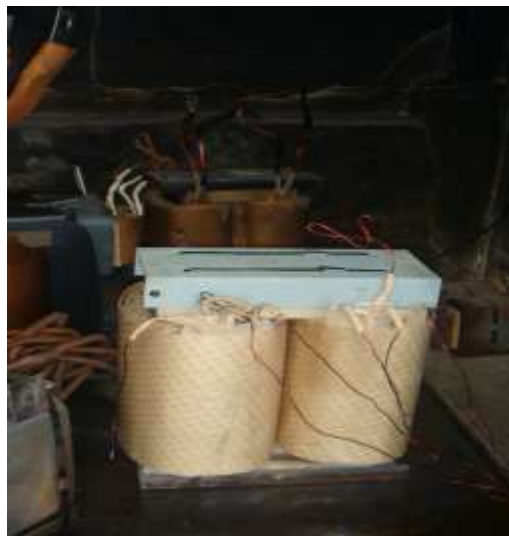
FIGURA 1.3 BOBINA Y NÚCLEO DE UN TRANSFORMADOR MONOFÁSICO
