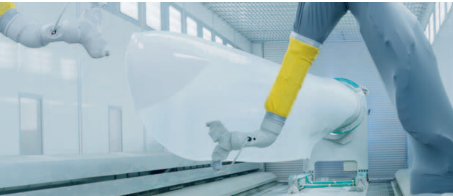
Un robot de pintura trabaja una pala de hasta 35 m de longitud en un solo paso y cuida de que su superficie reciba una protección perfecta contra las inclemencias del tiempo y la radiación UV, además de los factores como la erosión y la deformación
