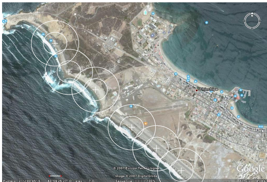
FIGURA 5.4. NIVELES DE RUIDO A 200 Y 400 METROS DE LOS AEROGENERADORES
