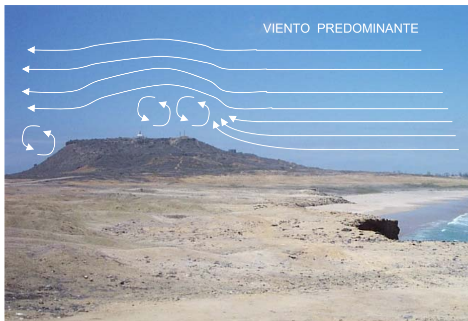
FIGURA 3.2. TURBULENCIA EN EL CERRO DE LA PUNTILLA
