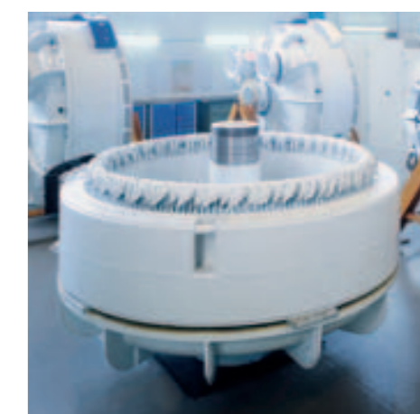
Estator (parte fija) de un generador en anilla ENERCON E-33
