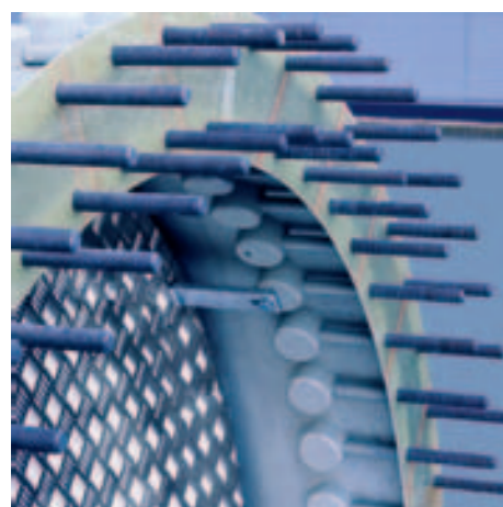
Las palas ENERCON E-70 con una unión atornillada de dos filas de pernos concede una seguridad extra mediante una distribución de cargas homogénea
