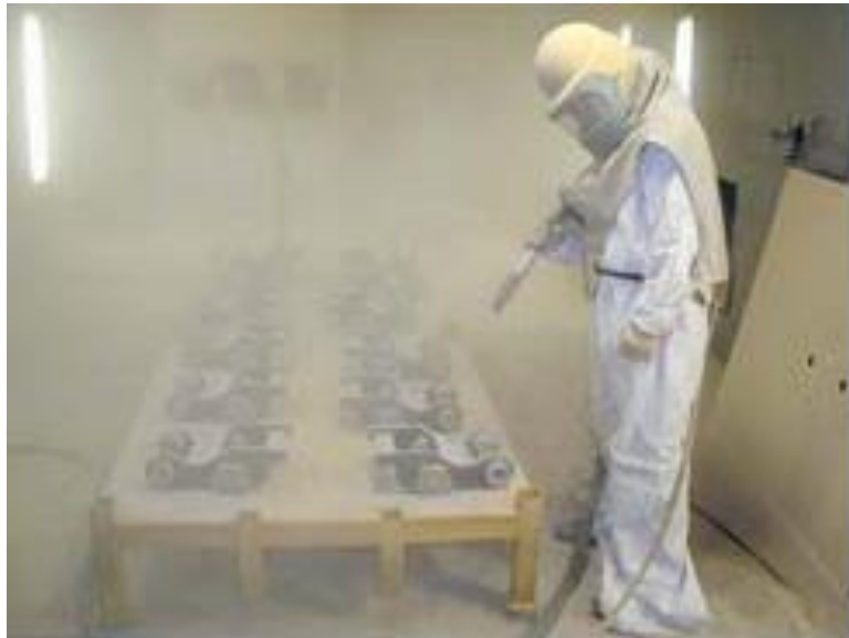
Polvo generado en zona cerrada al ambiente
