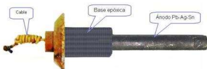
FIGURA 1.6 ÁNODO LISTO PARA SER USADO EN CONDENSADORES U2 O U3 DE LA CTGZ.
