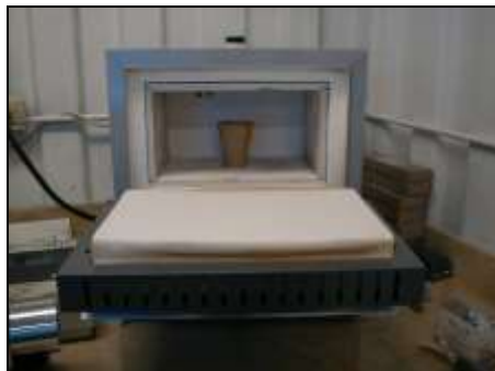
FIGURA 2.4 HORNO ELÉCTRICO CON CRISOL DENTRO.
