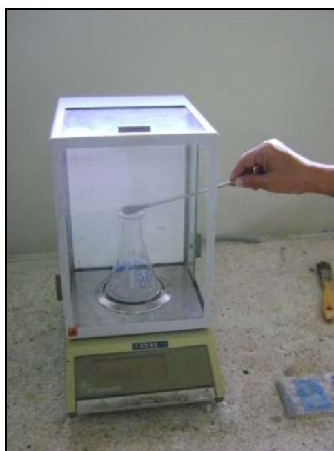
FIGURA 2.9 PESAJE DE VIRUTA DE LAS ALEACIONES.
