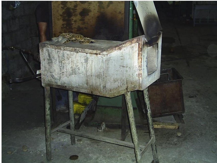
FIGURA 4.8 HORNO DE PRECALENTAMIENTO
