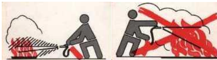
FIGURA 4.19 FORMA ADECUADA DE EMPLEAR EL EXTINTOR
