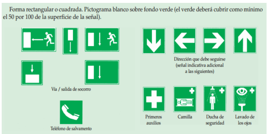
FIGURA 4.21 SEÑALES DE EVACUACIÓN
