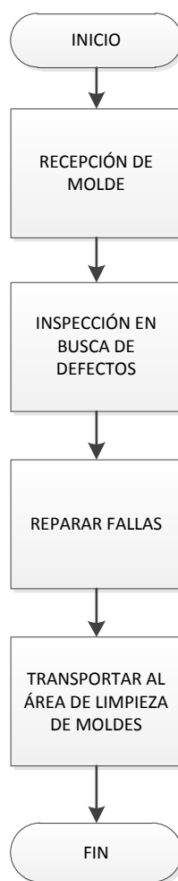
FIGURA 4.13 FLUJOGRAMA REPARACIÓN DE MOLDE
