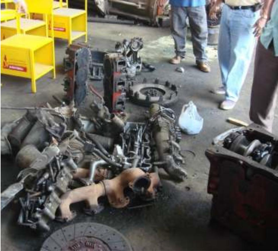
**FIGURA 2.16: Análisis situación actual: Protección componentes por armar**
