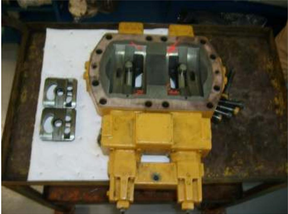
**FIGURA 2.27** Cabezal de bomba hidráulica dañada por contaminación
