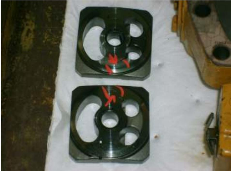
**FIGURA 2.29** Platos de presión dañados por contaminación
