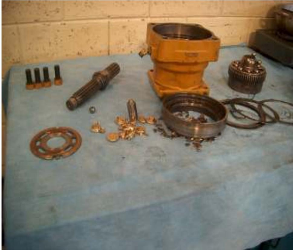
**FIGURA 2.30 Bomba Hidráulica dañada por tierra en el sistema**
