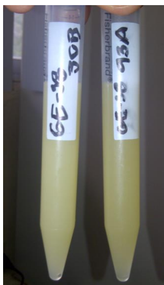
FIGURA 4.105 RESINA EPÓXICA GE-38 + NANOARCILLA 30B, 93A CON HORNO MINUTO 0.
