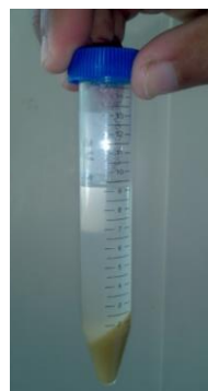
FIGURA 4.55 RESINA EPÓXICA GE-38 + NANOARCILLA NA MINUTO 15
