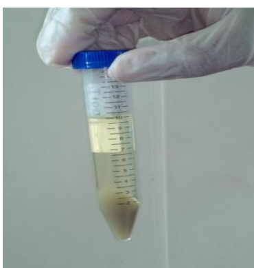
FIGURA 4.19 AMINA TEPA + NANOARCILLA 93A + INHIBIDOR MINUTO 15
