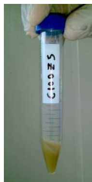
FIGURA 4.54 RESINA EPÓXICA GE-38 + NANOARCILLA 93A MINUTO 30
