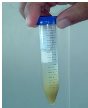
FIGURA 4.51 RESINA EPÓXICA GE-38 + NANOARCILLA 30B MINUTO 15
