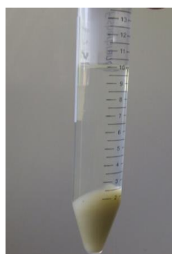
FIGURA 2.25 PRUEBA DE ASENTAMIENTO
