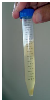
FIGURA 4.69 RESINA EPÓXICA GE-60 + NANOARCILLA 93A MINUTO 30.
