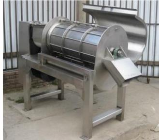
**Ilustración 15: Despulpadora de frutas**
