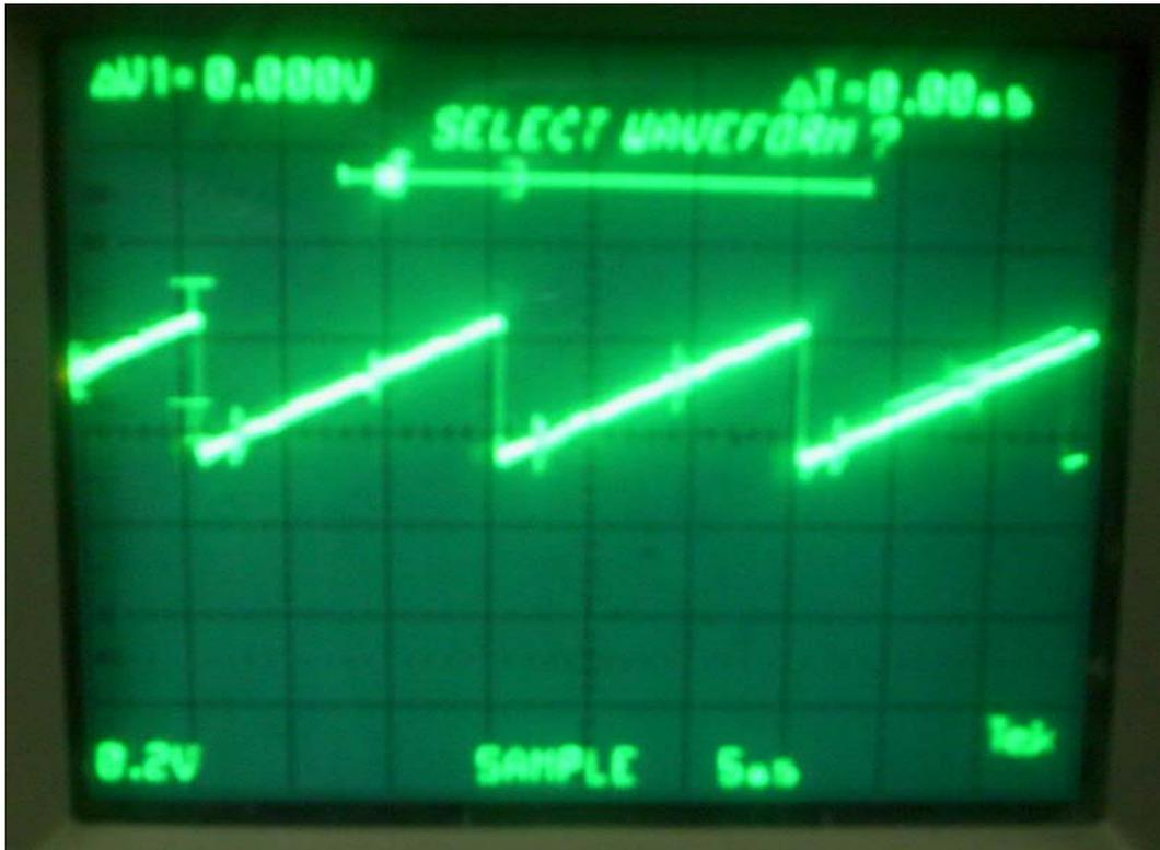
**Figura A2:** *Voltaje Triangular Generado por el CI “KA7500B”, utilizado para comparar internamente el valor de entrada de la realimentación.*
