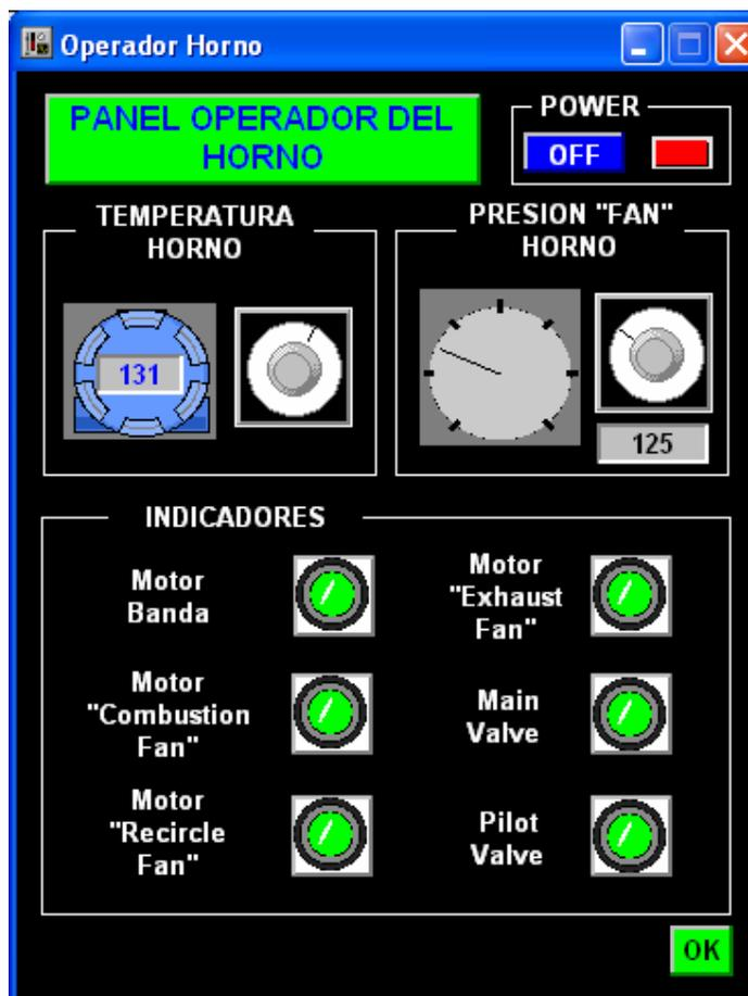
Figura 2. 15. Pantalla del panel de operador del horno.
