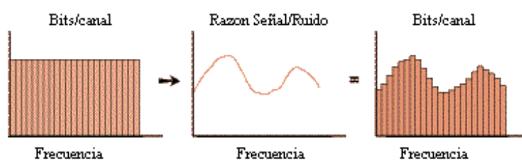
Figura 2-4: Modulación en presencia de una SNR
