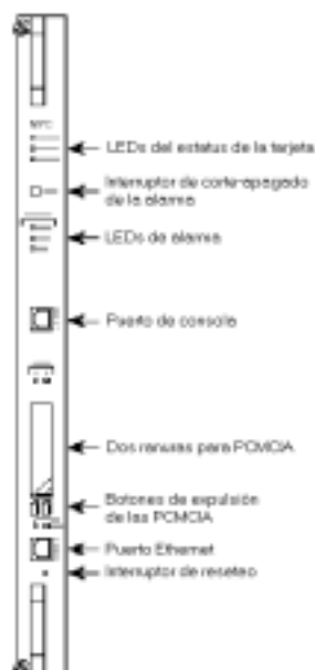
Figura 3-17: Vista frontal de tarjeta MPC
