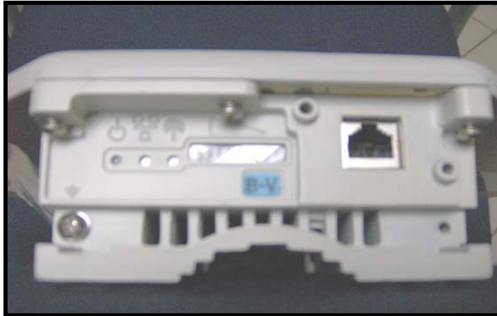
FIG. 4.24 Indicadores y conexión del equipo suscriptor
