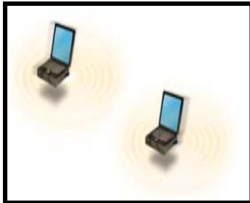
FIG. 1.2 Configuración Punto a Punto
