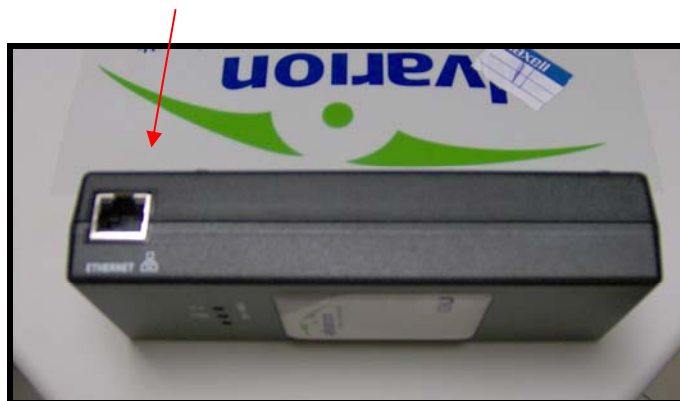
FIG. 4.26 Conector a Ethernet del adaptador de alimentación vía cable UTP (PoE).
