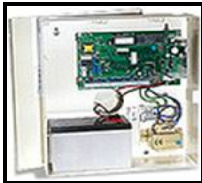
FIG. 2.3 Central de Alarmas o Panel de Control
