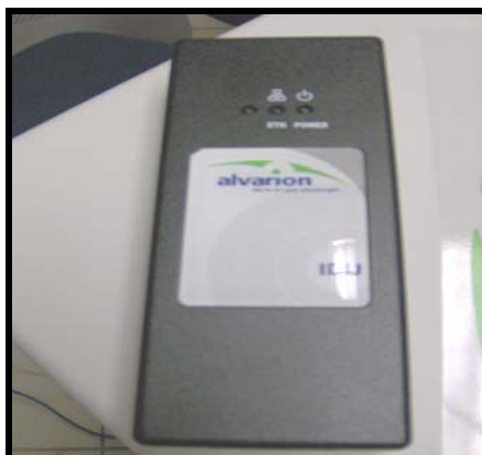
FIG. 4.25 El Adaptador de alimentación vía Cable UTP (PoE).
