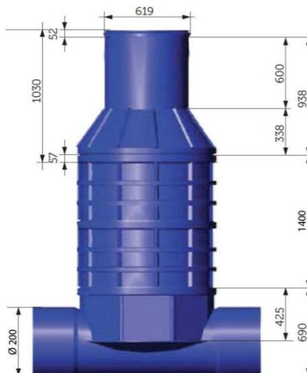
**Figura 8.- Manhole de Polietileno.**
