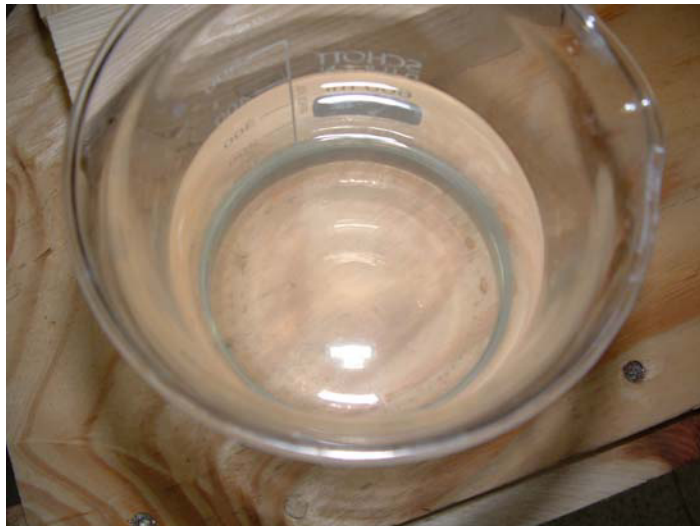
FIGURA 3.4. AGUA SOBRENANDANTE FILTRADA DESPUÉS DEL LAVADO.
