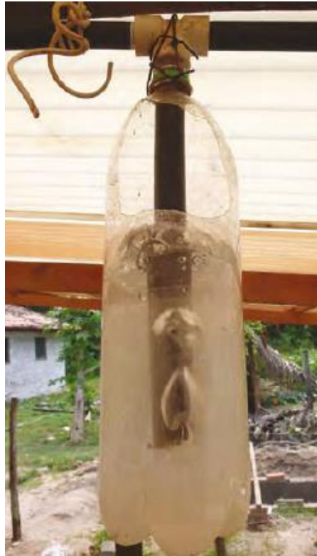
Figura 32. Válvula de seguridad de construcción manual
