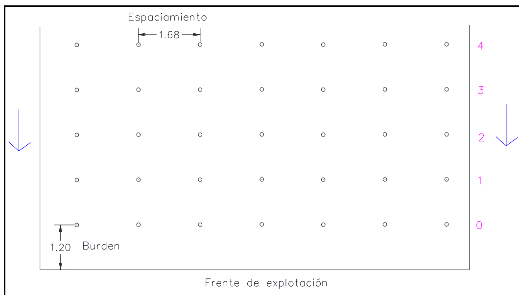
Figura N° 51.- Malla de voladura con un sistema de frontal de encendido.
