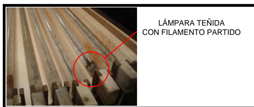
FIGURA 2.2. FALLO EN LÁMPARA INFRARROJA - CASO 1
