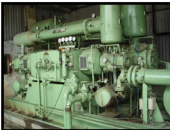
FIGURA 2.7. COMPRESOR DE CUATRO ETAPAS PARA AIRE COMPRIMIDO DE ALTA PRESIÓN
