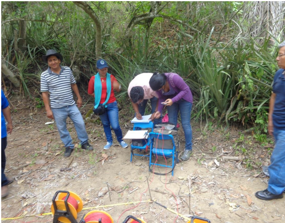
Figura 4.1 Realización del sondeo eléctrico vertical en Cadeate
