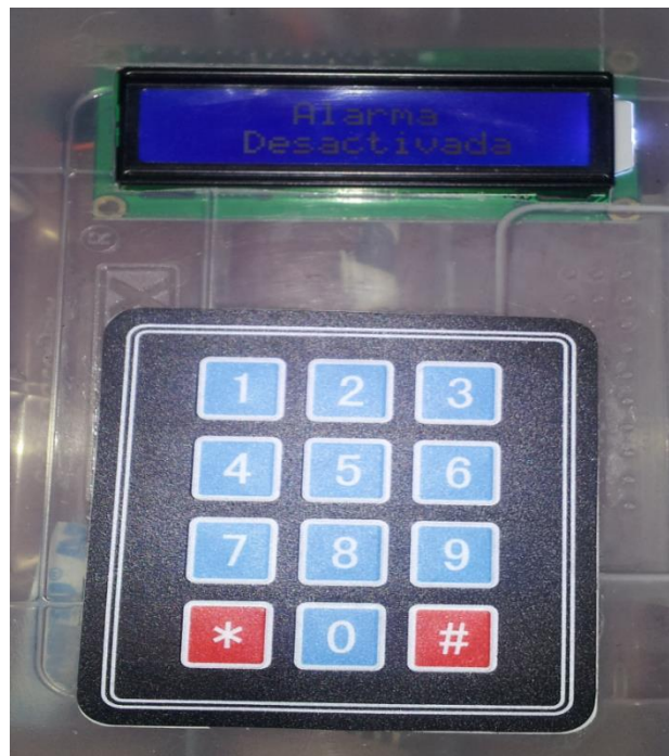
Figura 3.18: Panel de control mostrando el estado de la alarma
